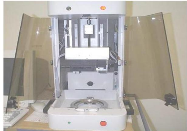
**Figure 4:** Universal Micro-Tribometer
